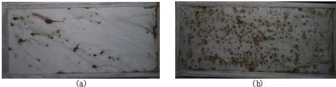
그림 5. 복합 사이클 시험 3 사이클 경과 후 STS 409L 표면. (a) 5 % NaCl, (b) 5 % CaCl 2
